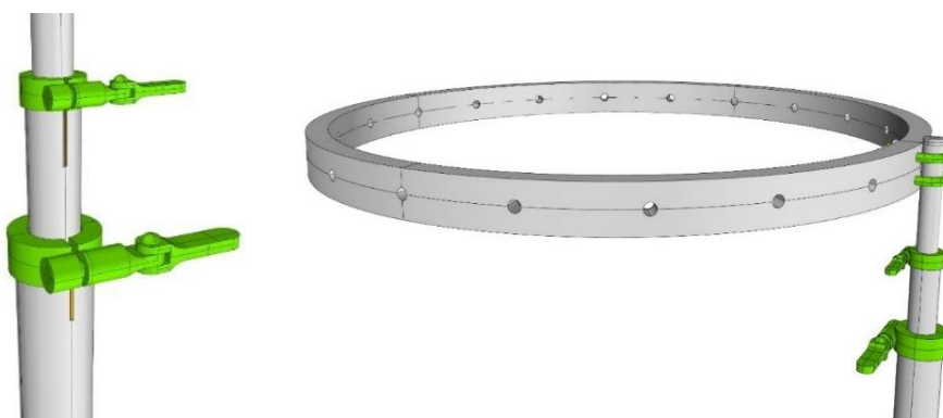
شکل ۶- استفاده از کرپی برای اتصال قطعات مختلف در دستگاه
